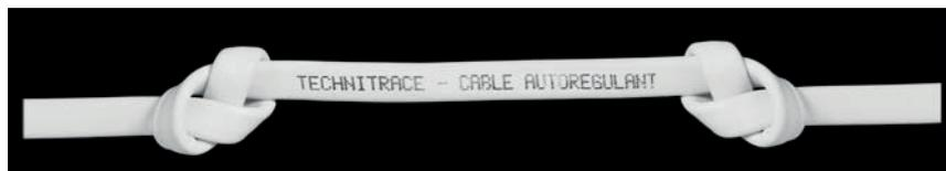
Les câbles chauffants autorégulants basse température CABT/FLEX sont constitués d'un élément chauffant plastique semi conducteur qui adapte en tout point sa puissance calorifique (W/m) en fonction de la température locale. Cette particularité intrinsèque de l'élément chauffant semi conducteur permet donc dans certains cas de se dispenser d'un système de régulation (autorégulation). Ils se coupent à la longueur sur le chantier et sont ainsi très simples de mise en oeuvre.
