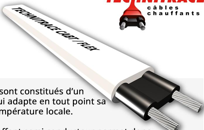
Les câbles chauffants autorégulants CABT/FLEX sont constitués d'un élément chauffant plastique semi conducteur qui adapte en tout point sa puissance calorifique (W/m) en fonction de la température locale.
