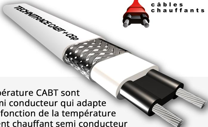
Les câbles chauffants autorégulants basse température CABT sont constitués d'un élément chauffant plastique semi conducteur qui adapte en tout point sa puissance calorifique (W/m) en fonction de la température locale. Cette particularité intrinsèque de l'élément chauffant semi conducteur permet donc dans certains cas de se dispenser d'un système de régulation (autorégulation).
