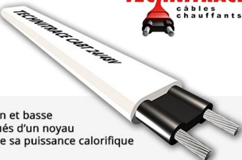
Les câbles chauffants autorégulants basse tension et basse température CABT/24V et CABT/48V sont constitués d'un noyau chauffant en plastique semi-conducteur qui ajuste sa puissance calorifique ( $W/m$ ) en fonction de la température locale.
