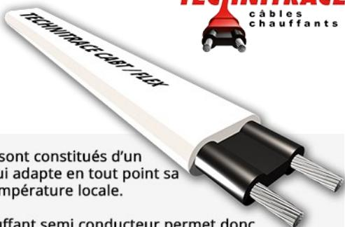
Les câbles chauffants autorégulants CABT/FLEX sont constitués d'un élément chauffant plastique semi conducteur qui adapte en tout point sa puissance calorifique (W/m) en fonction de la température locale.
