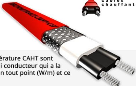
Les câbles chauffants autorégulants haute température CAHT sont constitués d'un élément chauffant plastique semi conducteur qui a la particularité d'adapter sa puissance de chauffe en tout point (W/m) et ce en fonction de la température locale.
